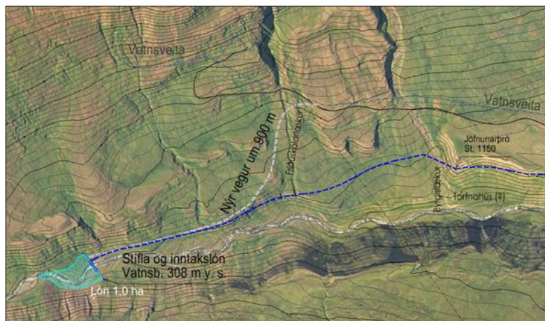
Mynd 16: Vegur frá vatnsveituvegi að stíflustæði samkvæmt kosti II
